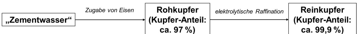
Abbildung 1: Schritte der Gewinnung von Reinkupfer aus „Zementwasser“
