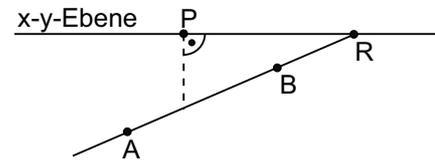
Willst du ausgehend davon die Koordinaten des Punktes  $P$  bestimmen, an welchem der Notausstiegstunnel an der Erdoberfläche endet, so musst du zunächst jenen Punkt auf der Strecke  $\overline{AB}$  bestimmen, an welchem der Notausstiegstunnel auf den Tunnel trifft.
